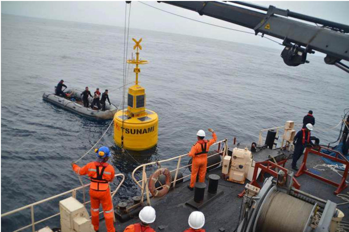
Fotografía: Boya 1 EBM22-TSU ubicada a 600 millas náuticas de la costa de Manta instalada desde 2011 a una profundidad de 1600 m.
